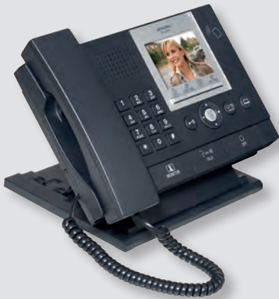
GT-MKB-N Servicestation med NFC funktion
